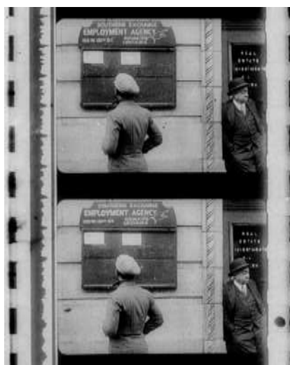
图 7：印有声迹的正片（变积式）
